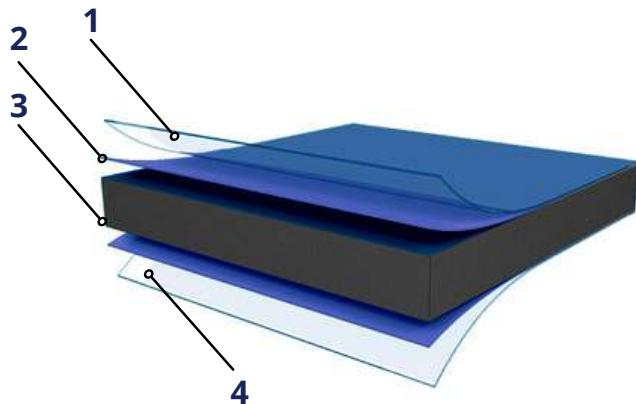
**1.** Защитный слой - обеспечивает защиту внутреннего декоративного слоя от разрушения под действием солнечных лучей.
